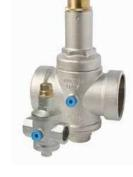
1/4"G, posti sul corpo, permettono il collegamento di un manometro di controllo. Misure disponibili da 1/2"G fino a 4"G. Pressione massima d'esercizio consigliata: 25 bar. Regolazione: collaudato e tarato ad una pressione di uscita di 3 bar. Campo di regolazione pressione in uscita da 0,5 a 7 bar a seconda delle misure. Temperatura massima di utilizzo: 120°. L'Art. 504, come tutti i riduttori di pressione F.A.R.G. sono a norma EN1567.
